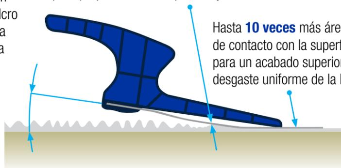
Hasta **10 veces** más área de contacto con la superficie para un acabado superior y un desgaste uniforme de la hoja
