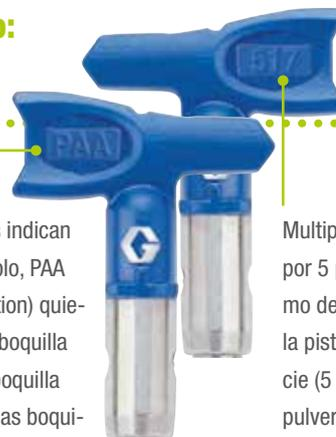
Multiplique el primer dígito (5) por 5 para obtener el ancho mínimo de pulverización al mantener la pistola a 30 cm de la superficie ( $5 \times 5 = 25$  cm de ancho de pulverización). Los dos últimos dígitos (17) corresponden a la apertura, que en este caso es de 0,017 pulgadas.
