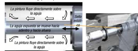
La pintura fluye directamente sobre la aguja que se mueve dentro y fuera de un sello estático, generando el desgaste de la aguja con cada activación del gatillo.
