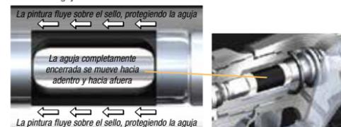
La aguja está completamente encerrada por el FlexSeal para proporcionar un cierre uniforme y rápido, reduciendo la expulsión de material.
