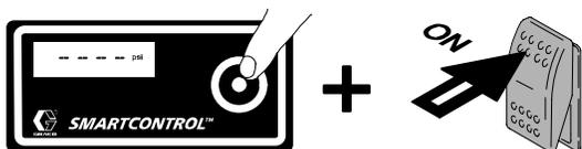
2. Pulse simultáneamente el botón DTS y coloque el interruptor de encendido/apagado de la bomba en posición ON.
