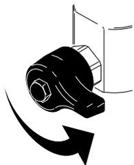
10. Coloque la válvula de cebado en posición horizontal.
