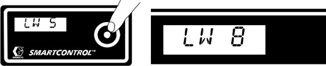
7. Pulse y mantenga pulsado el botón DTS para cambiar la LW. LW cambia desde 5 – 30 cm (2 – 12 pulg.). Suelte el botón DTS cuando aparezca la LW deseada.
