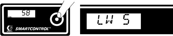
6. Pulse brevemente el botón DTS para avanzar hasta el Selector de Anchura de la línea (LW).
