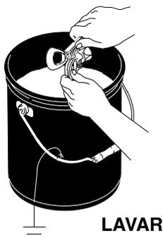
17. Limpie la boquilla, la protección y la junta con un cepillo suave para evitar su deterioro debido a la acumulación de producto seco. Ensamble las piezas y sujételas, sin apretarlas demasiado, en la pistola.
