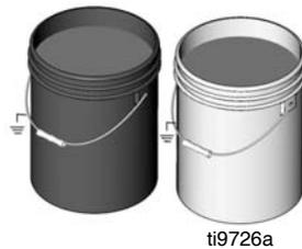
4. Extraiga el tubo de succión y el tubo de cebado del bote de pintura. Permita que escurran en el bote de pintura por un momento.
