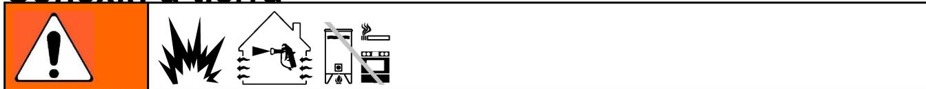
El equipo debe estar conectado a tierra. La conexin a tierra reduce el riesgo de descargas elctricas y estticas al proporcionar un cable de escape para la corriente elctrica generada por la acumulacin esttica o en caso de cortocircuito.
