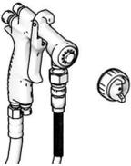
3. Coloque el tubo de aspiracin en el disolvente.
