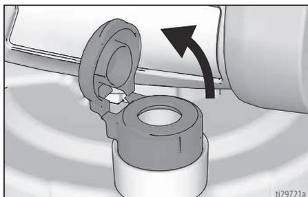
5. Abra la tapa del VacuValve. Incline el pulverizador de forma que el VacuValve se encuentre en el punto más alto, lo que provoca que el aire existente en el FlexLiner suba hasta el VacuValve. Oprima suavemente el FlexLiner para evacuar todo el aire a través del orificio de aire del VacuValve. Una vez vea que el material entra en el depósito del VacuValve, debe haberse evacuado todo el aire del FlexLiner.
