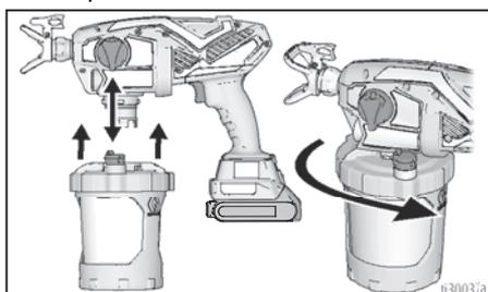
4. El VacuValve es una parte importante de su nuevo pulverizador. Se utiliza para evacuar el aire del FlexLiner. Su pulverizador no rociará si hay aire en el FlexLiner.
