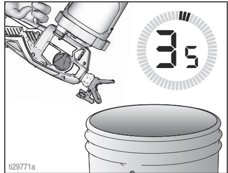
9. Gire la perilla de cebado de bomba/pulverización hacia la posición de pulverización. Retire el conjunto de copa y vierta de nuevo el Pump Armor restante en su botella. Sustituya la tapa a prueba de niños y apriétela firmemente para almacenarlo.
