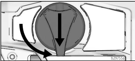
3. Separe el soporte de copa con el FlexLiner de la cubierta de copa/pulverizador. Coloque el pulverizador hacia abajo sobre una superficie plana.
