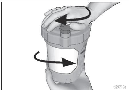
6. Alinee el VacuValve de la cubierta de la copa con la perilla de cebado de la bomba/pulverización. Empuje el conjunto de copa en el pulverizador y gírelo para bloquearlo.
