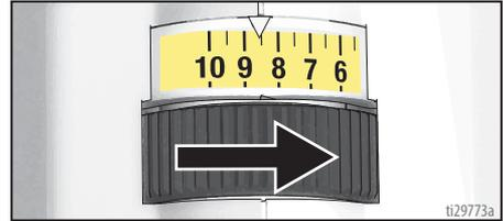
El control de velocidad permite infinitos ajustes de presión. Para evitar la pulverización excesiva, empiece siempre con la velocidad más baja y vaya incrementando la velocidad poco a poco hasta que obtenga un patrón de pulverización aceptable.
