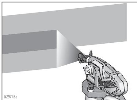
Al girar el protector de la boquilla de pulverización se cambia la orientación del patrón a horizontal o vertical.
