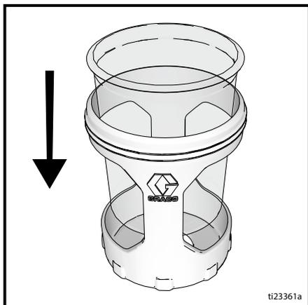
2. Llene FlexLiner con material. Apriete firmemente la cubierta de copa en el soporte de copa. Para un correcto funcionamiento del pulverizador, la tapa debe estar firmemente colocada sobre el vaso.
