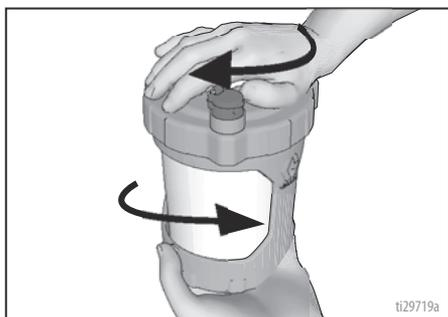
3. Alinee el VacuValve de la cubierta de la copa con la perilla de cebado de la bomba/pulverización. Empuje el conjunto de copa en el pulverizador y gírelo para bloquearlo.
