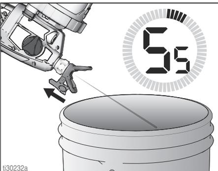
13. Si se ha utilizado la segunda boquilla de pulverización, saque la boquilla de pulverización limpia del portaboquillas e instálela. Consulte **Instalación de la boquilla de pulverización**, página 22. Repita los pasos 11 y 12 para limpiar la segunda boquilla de pulverización.
