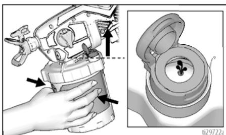
6. Deje de oprimir el FlexLiner y cierre la tapa del VacuValve. Escuchará el clic cuando se cierra la tapa correctamente.
