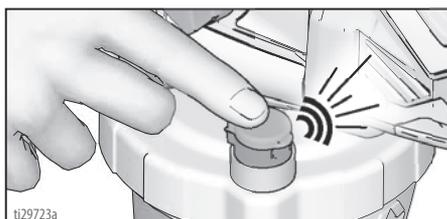
7. Instale la batería en el pulverizador.
