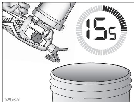
11. Gire la perilla de cebado de bomba/pulverización hacia la posición de pulverización.
