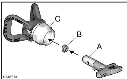
3. Inserte la boquilla de pulverización. La boquilla de pulverización debe empujarse hasta el fondo del protector de boquilla.
