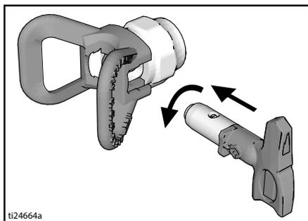
4. Enrosque el conjunto de la boquilla de pulverización y el protector de la boquilla en la pistola y apriételo bien.
