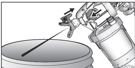
5. Gire la perilla de cebado de bomba/pulverización hacia abajo hasta la posición de cebado. Gire la boquilla de pulverización de vuelta a la posición PULVERIZAR. Gire la perilla de cebado de bomba/pulverización hacia delante hasta la posición de pulverización y reanude la pulverización.
