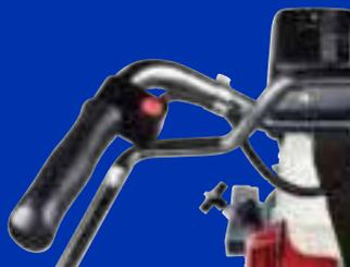
**Control eléctrico de la pistola:** con solo presionar un botón rojo, cambia las pistolas de pintura y microesferas de manual a automático.
