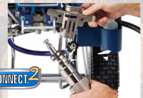
**ProConnect™ 2** Este diseño de próxima generación sin clavijas del Sistema de extracción e instalación de bomba ProConnect de Graco hace que sea más fácil y rápido que nunca sustituir la bomba en cuestión de segundos.
