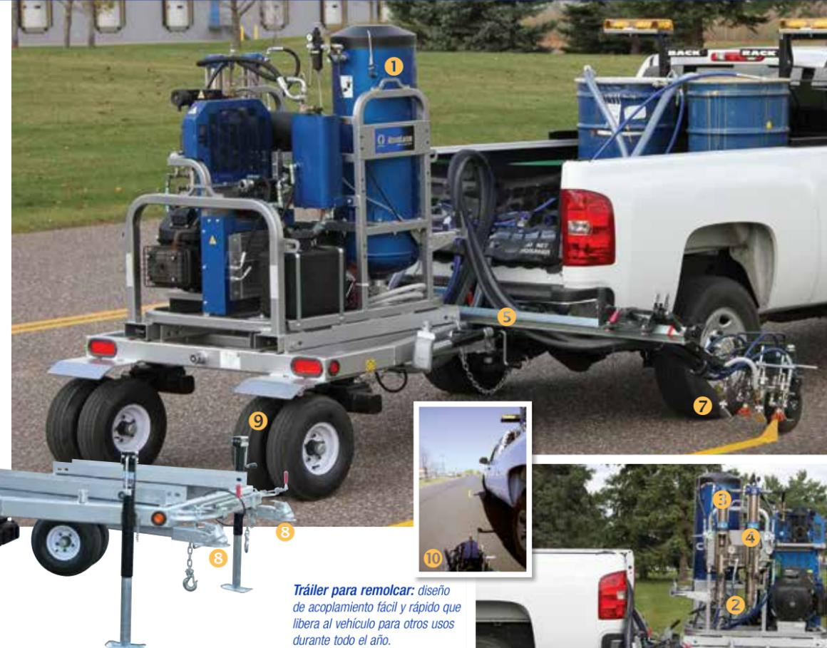
**Tráiler para remolcar:** diseño de acoplamiento fácil y rápido que libera al vehículo para otros usos durante todo el año.
