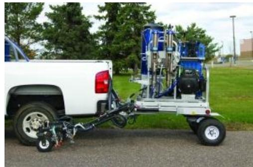
**Sistema de enganche dual:** el diseño patentado hace que los enganches sean parte del vehículo de trazado de líneas, avanzando con el camión, no detrás de él, brindando líneas más rectas y transiciones con menos complicaciones en las curvas.
