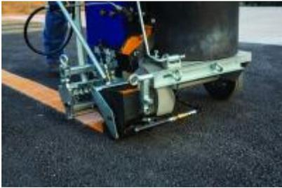
**FlexDie :** Entrega una excelente calidad de línea con una construcción exclusiva de matriz profunda completamente de acero y diseño de cambio sin herramientas.
