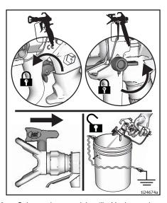
Coloque el seguro del gatillo. Vuelva a colocar la boquilla de pulverización en su posición original. Quite el seguro del gatillo y siga pulverizando.
