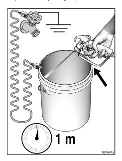
Apunte la pistola hacia el bidón de pintura y dispárela durante 20 segundos. Suelte el gatillo y permita que el pulverizador acumule presión. Coloque el seguro del gatillo.
