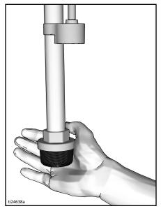
Llene la tuerca de la empaquetadura del cuello con TSL para evitar el desgaste prematuro de la empaquetadura. Haga esto a diario o cada vez que pulverice.
